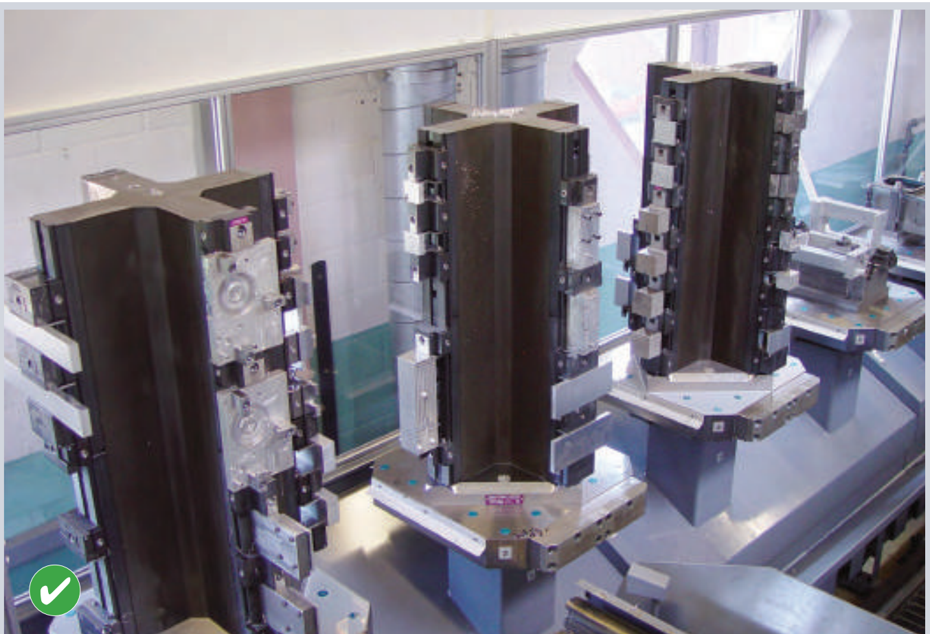
Serrage de pièces différentes possibles avec notre système modulaire. Utilisation optimale d'un centre d'usinage horizontal.
