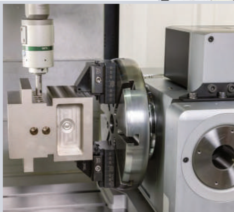
Serrage sur diviseur 5 axes.
