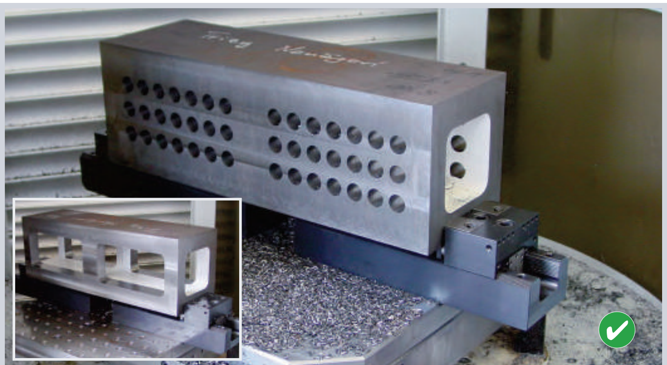
Sur et rapide avec un serrage de 7 t, bonne accessibilité
