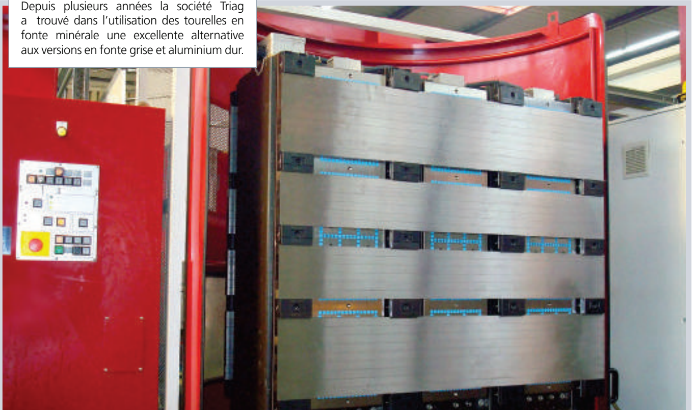
Tourelle fonte minérale équipée avec Power Clamp combiné à un plateau magnétique
