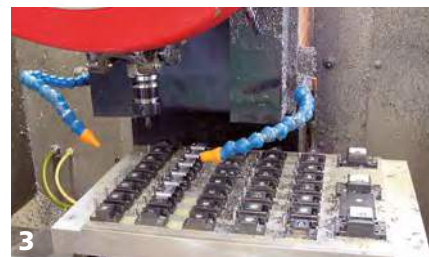
Image 3. Les applications du système de serrage multiple dans la fabrication de petites séries réduisent le changement d'outils et augmente la rentabilité.
