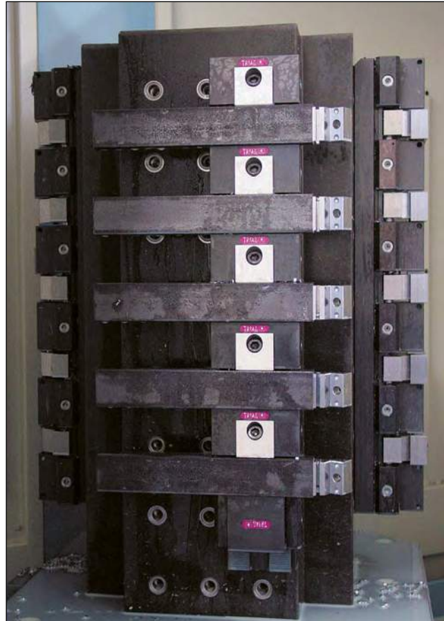
7 Aufspannung mit Power Clamp auf einem „Triplex“ Mineralgussturm Set up with Power Clamp on a tombstone made of composite concrete Serrage Power Clamp sur une tourelle à minérale coulée
