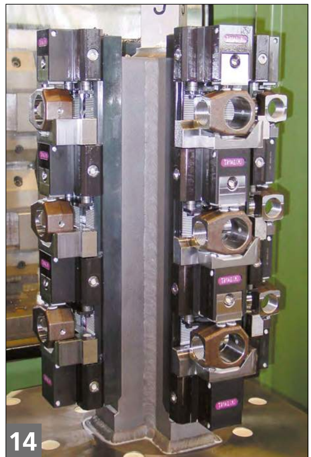
Einzelspannung einer grossen Platte auf «tripoxy» Mineralgussturm Single set up of a large plate on tombstone made of composite concrete Serrage simple d'une grande plaquette sur une tourelle à minérale coulée
