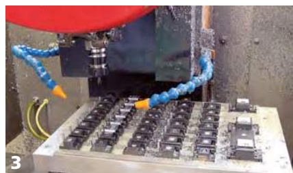
Bild 3. Die Verwendung von Mehrfachspannsystemen auch in der Kleinserienfertigung reduziert den Werkzeugwechsel und erhöht die Wirtschaftlichkeit
