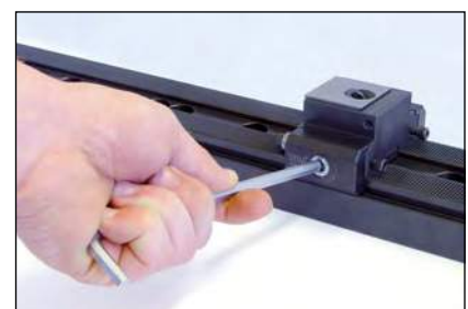
3. Eine Schraube anziehen Fasten one screw Serrer une vis
